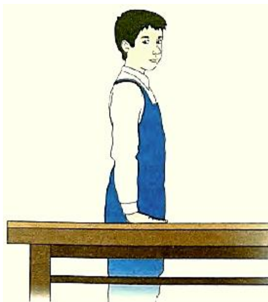
Рис. 16. Соответствие верстака росту работающего
